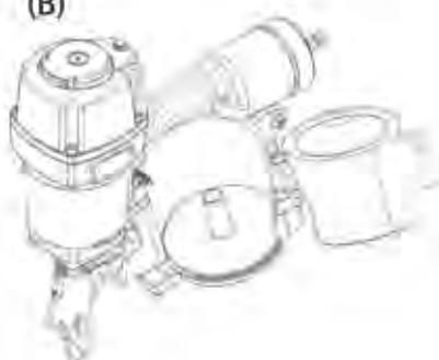
Dans le cas du système pour cloueur de bobine(B),on appuie sur le crochet et on ouvre le clapet.
